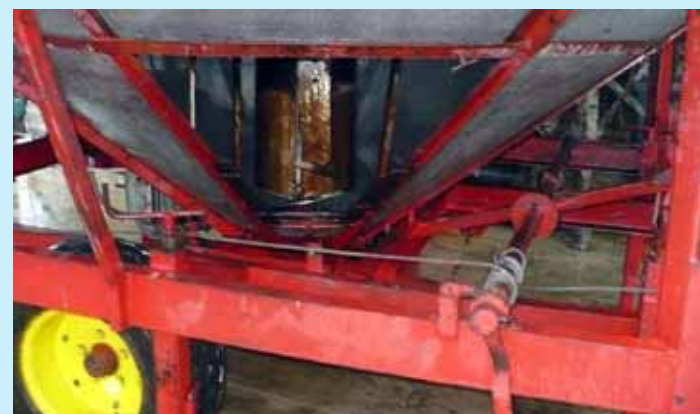
Brak części obudowy – osłony elementów obrotowych mieszadeł, wadliwe śruby do mocowania obudowy.
