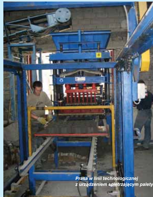
Prasa z przenośnikiem łańcuchowym transportującym palety z pustakami
