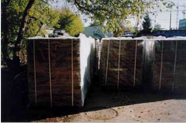
Zhermetyzowane płyty PW3/A na paletach przed transportem na składowisko
